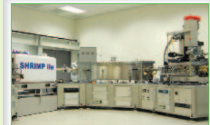
고분해능 이차이온질량분석(HR-SIMS) 전자석 반경 1 m(질량분해능 10,000) 본원(오창) / 2009년 설치
