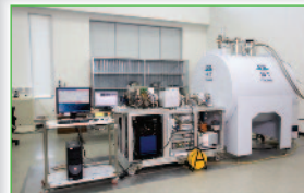
초고분해능 질량분석기(UHR FT-ICR) 15 T FT-ICR MS(분해능 3,500,000) 본원(오창) / 2008년 설치
