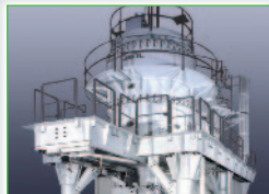
초고전압 투과전자현미경(HVEM) 1.3 MeV TEM(공간분해능 0.12 nm) 본원 / 2004년 설치
