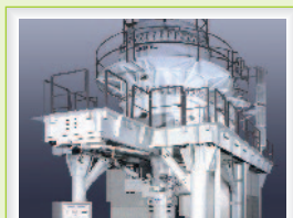
초고전압 투과전자현미경(HVEM) 1.3 MeV TEM(공간분해능 0.12 nm) 본원 / 2004년 설치
