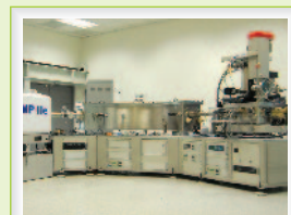
고분해능 이차이온질량분석(HR-SIMS) 전자석 반경 1 m(질량분해능 10,000) 본원(오창) / 2009년 설치
