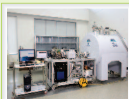
초고분해능 질량분석기(UHR FT-ICR) 15 T FT-ICR MS(분해능 3,500,000) 본원(오창) / 2008년 설치
